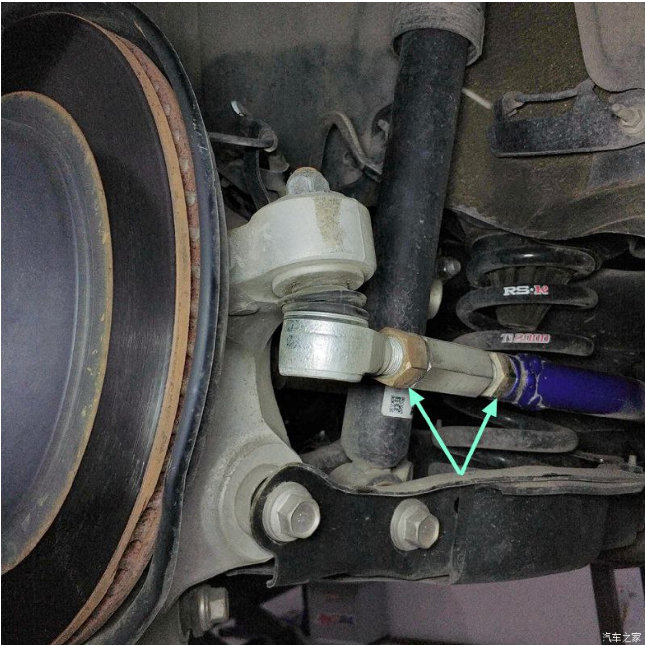
△这是上次给车友做定位时候发现的问题，在车辆举升，悬挂完全下垂的状态下，这个球头是很正的，想必当时店家就是直接装上拧紧的，图片里是避震弹簧处于模拟落地时候的压缩状态，明显看到这个球头下端偏转一定的角度，如果行驶中出现大幅度颠簸，悬挂再向上运动，很容易逼近这个球头的死点，可能会导致球头胶套破裂，或者球头提前损坏
